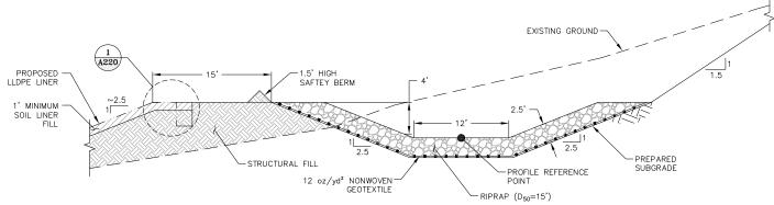
AX AX AX AX TYPICAL RIPRAP-LINED CHANNEL SECTION PHASE 2
