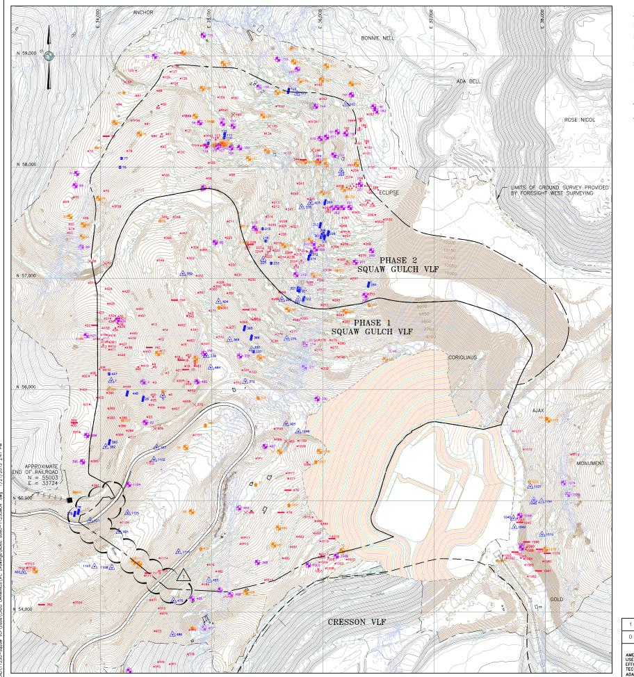
5900 EXISTING GROUND CONTOUR AND EL, FEET (AERIAL SURVEY) 5900 EXISTING GROUND CONTOUR AND EL, FEET (LAND SURVEY) MILL PLATFORM GROUND SURFACE CONTOUR EL, FEET
